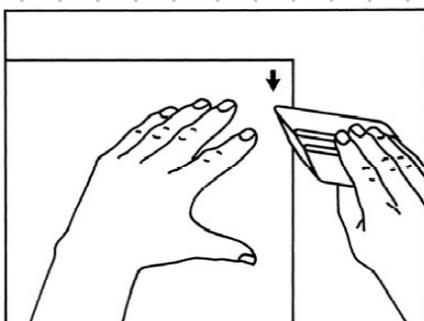
5 | Diesen Schritt solange wiederholen, bis die Folie komplett verklebt ist. Entfernen Sie dabei immer nur ein Stück des Abdeckpapiers und drücken Sie dann das freigelegte Stück Folie fest. Anschließend wird der lange Streifen Kreppband abgezogen. Das Ergebnis wird kontrolliert und ggf. mit einem Rakel nachgebessert.
