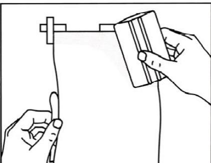
4 | Die Folie nun ein wenig anheben und das Abdeckpapier ca. 15–20cm abziehen. Die Folie dicht genug am Untergrund halten und mit dem Rakel von der Mitte der bereits klebenden Seite aus allmählich immer weiter nach außen streichen. Diesen Vorgang solange wiederholen, bis die ganze Folie verklebt ist.
