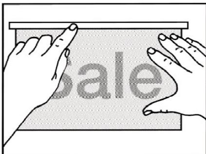
1 | Die Folie einschließlich Abdeckpapier und Application Tape mit Stücken von Kreppband in der gewünschten Position befestigen und anschließend ein „Scharnier“ Kreppband horizontal oder vertikal anbringen.
