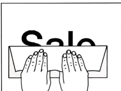
4 | Nun wird das Application Tape in einem Winkel von 180° abgezogen. Nach dem Verkleben der Folie, sollte möglichst ein paar Minuten mit dem Abziehen gewartet werden, damit keine Luftbläschen entstehen. Anschließend werden die Ränder der einzelnen Folienstücke kontrolliert und bei Bedarf noch einmal nachgedrückt.
