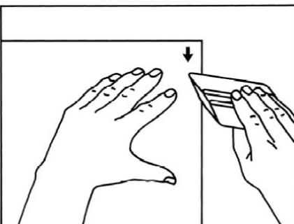
5 | Anschließend erfolgt eine Kontrolle: Haftet der Folienrand überall gut? Ansonsten noch einmal mit dem Rakel andrücken. Kleine Blasen können mit einer Nadel aufgestochen werden, um daraufhin die Luft vom Rand der Blase heraus zu drücken.
