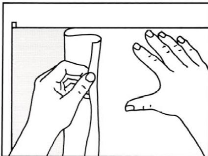
3 | Die kurzen Streifen können nun entfernt werden. Die Folie wird nun auf das seitlich entstandene „Scharnier“ auf den Rücken gelegt. Das Abdeckpapier ca. 20 – 30 cm entfernen und parallel zum Scharnier falten, damit es nicht wieder auf das abgezogene Stück Folie zurückfällt.
